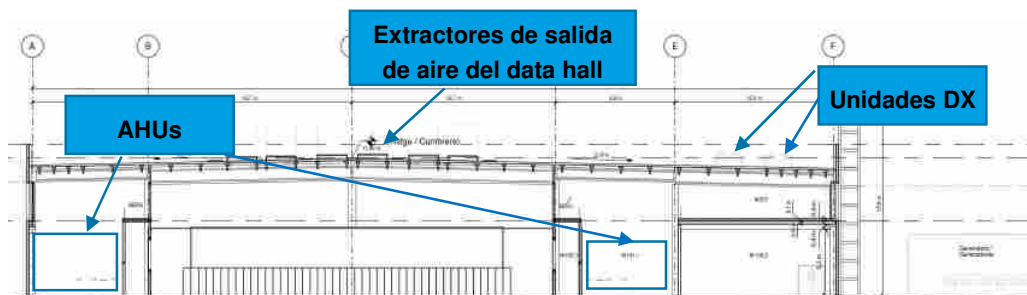
Figura 5.7 Diagrama del sistema de climatización previsto
